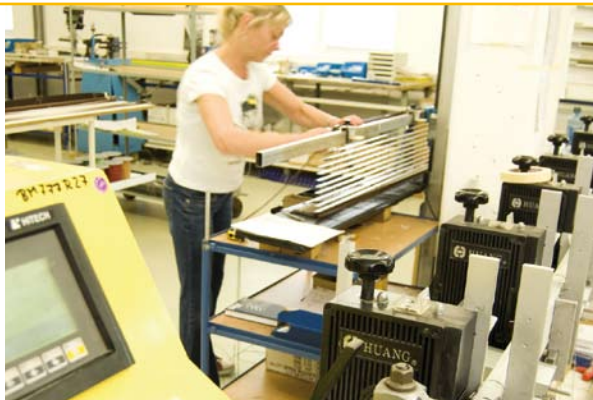
Jalousiefertigung mit Stanz und Fädelautomaten
