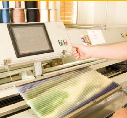
Plisseekonfektion mit Schienenautomaten, automatischer Stoffbohrung und Fädelautomaten
