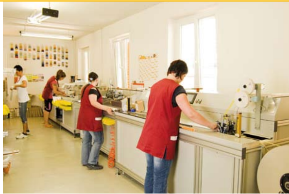
Plisseekonfektion mit Schienenautomaten, automatischer Stoffbohrung und Fädelautomaten
