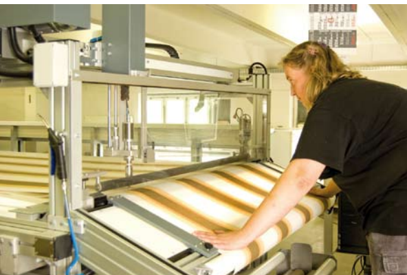
Zuschnitt von Markisentstoffen mit Ultraschallschneidetischen und Verschweissen mittels Ultraschallautomaten
