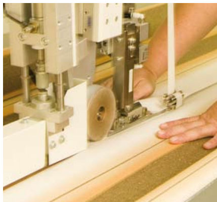
Zuschnitt von Markisentstoffen mit Ultraschallschneidetischen und Verschweissen mittels Ultraschallautomaten
